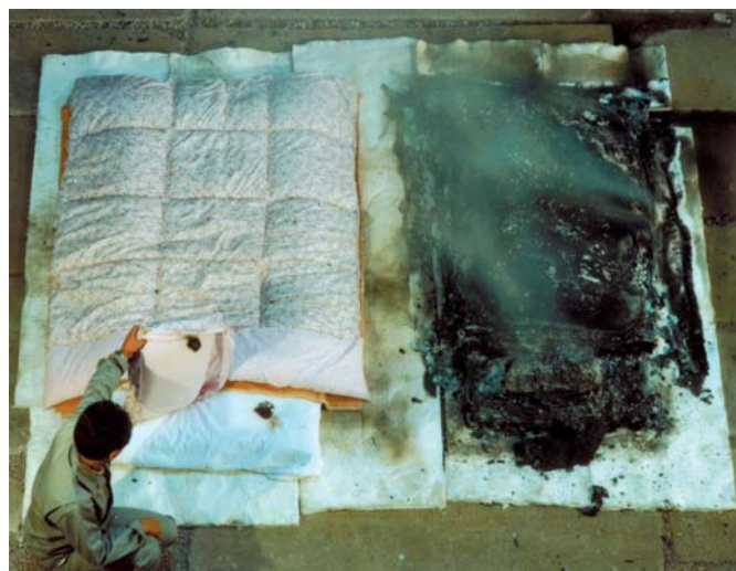
ふとん燃焼実験 (左:防災品 右:非防災品) ～たばこを布団におき、同時着火1時間～
